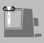
Filter herausdrehen / eindrehen (im Wassertank)
